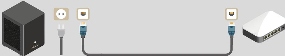
Verbinde den RenderCube mit Stromkabel und Netzwerk und schalte ihn ein. Über deinen Router erhält der RenderCube automatisch eine IP Adresse.
